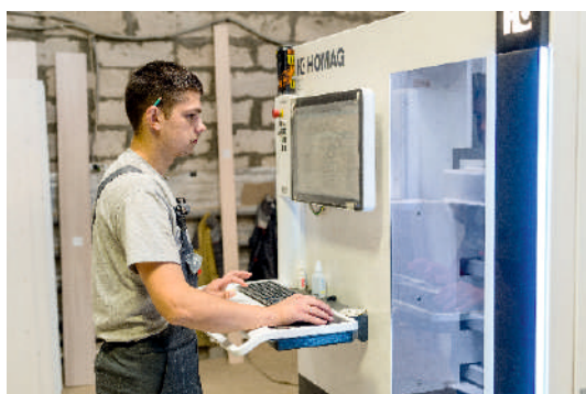
сверлильно-присадочный станок от немецкой компании Homag
